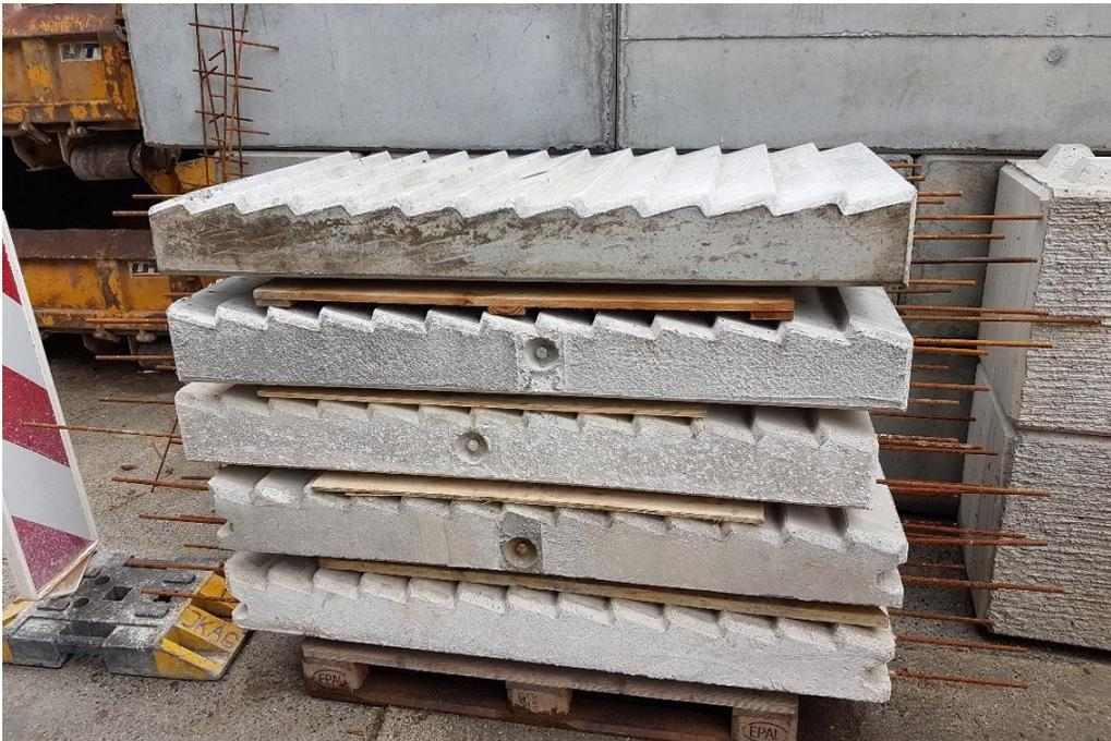
Abbildung 9: Vorfabrizierte Betonspurelemente "System Küttel"
