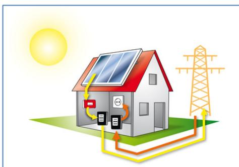
Abbildung 1 PV-Anlage: Integration ins Stromnetz
